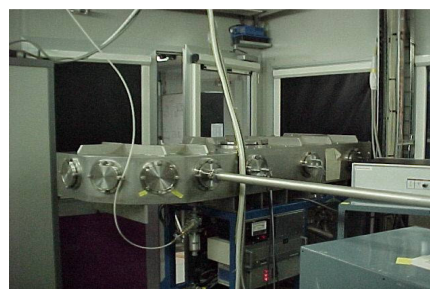
Rys.1 Zdjęcie spektrometru krystalicznego typu von Hamos zainstalowanego w układzie ID21 ESRF.
